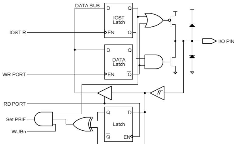
上拉/下拉和漏极开路在图中未显示
